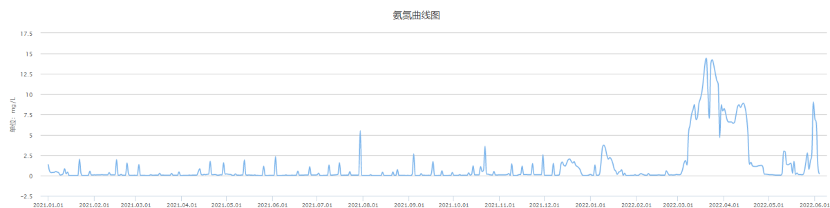
图 3.2.10-4 老厂区废水总排口氨氮曲线在线监测浓度图
