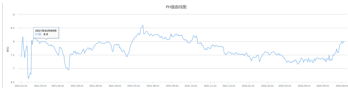
图 3.2.10-2 老厂区废水总排口 pH 在线监测浓度图
