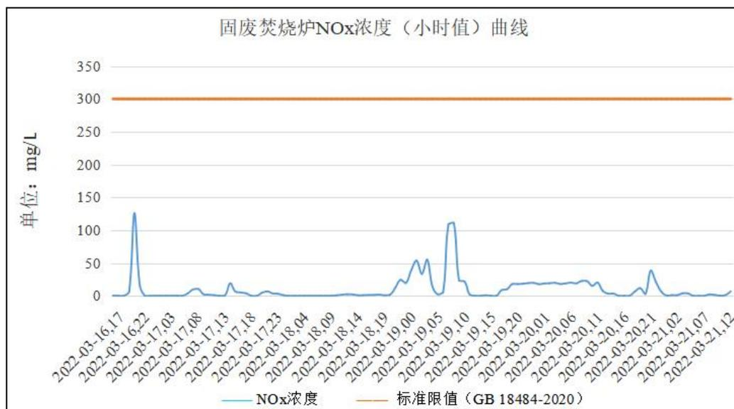
图 3.2.11-12 固废焚烧炉排放口 NOx 浓度（时均值）在线监控数据
