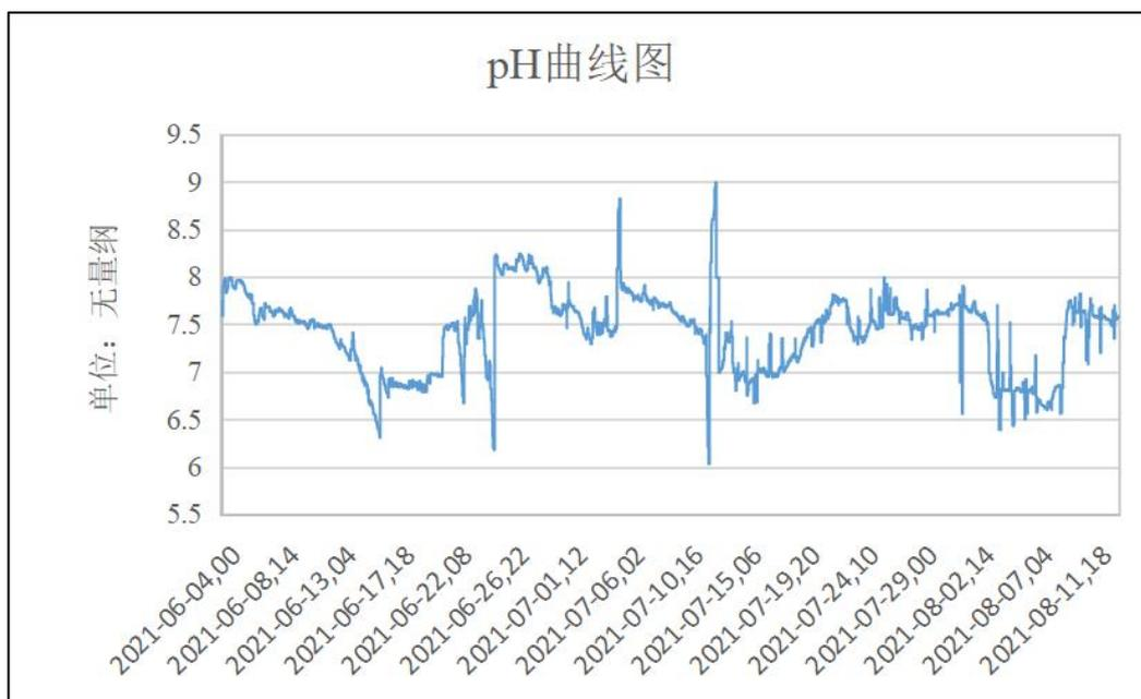
图 3.2.11-5 污水排放口 pH 在线监测曲线
