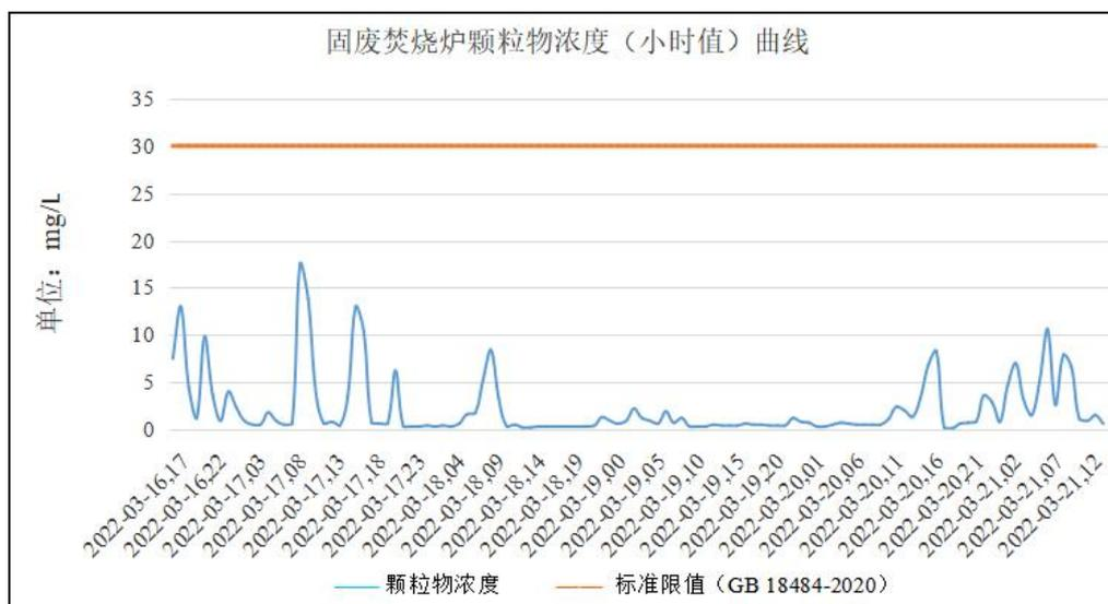
图 3.2.11-13 固废焚烧炉排放口颗粒物浓度（时均值）在线监控数据
